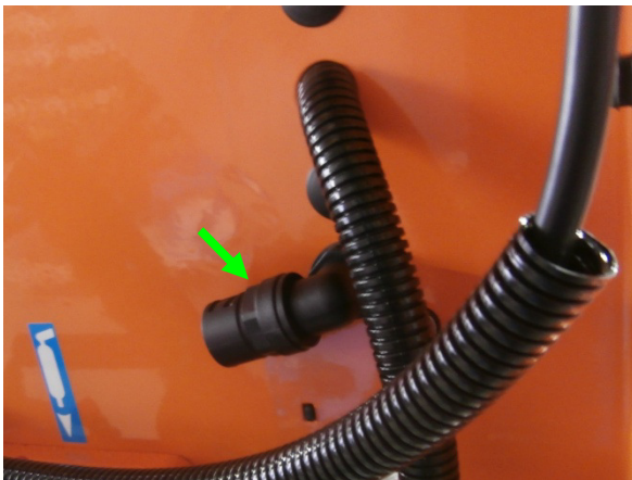
Abb. 13 Winkelverschraubung montiert / Leitung verlegt
